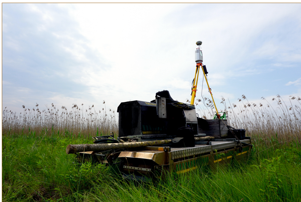
Ryc. 5. Stanowisko pomiarowe TLS zamontowane na ratraku przystosowanym do koszenia traw.
