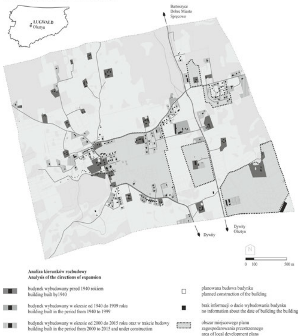
Ryc. 1. Analiza kierunków rozbudowy układu ruralistycznego wsi Ługwałd
